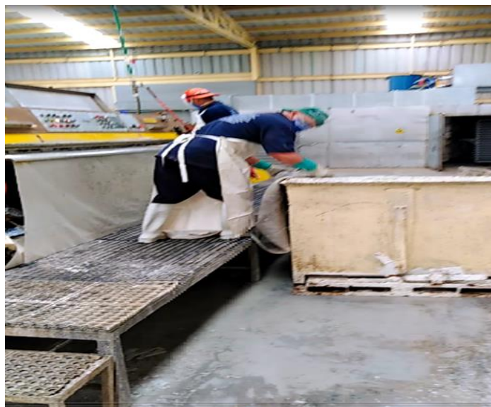
Imagen 14. Operadores tomando los cueros del hopper para meterlos a dividir. Fuente: Tomada por los autores, (Planta Principal. 2021)
