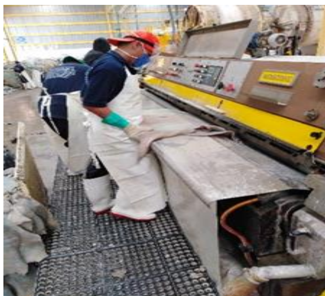
Imagen 15. Operadores metiendo los cueros a la máquina divididora. Fuente: Tomada por los autores, (Planta Principal. 2021)
