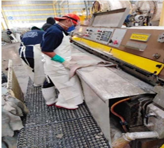
Imagen 9. Operación de rasurar. Fuente: Tomada por los autores, (Planta Principal. 2021)
