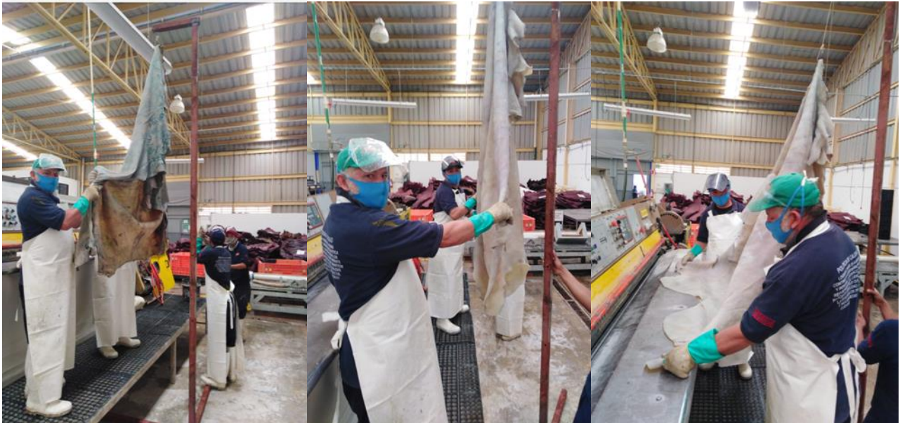
Imagen 26. Cueros transportándose mediante el conveyor.
