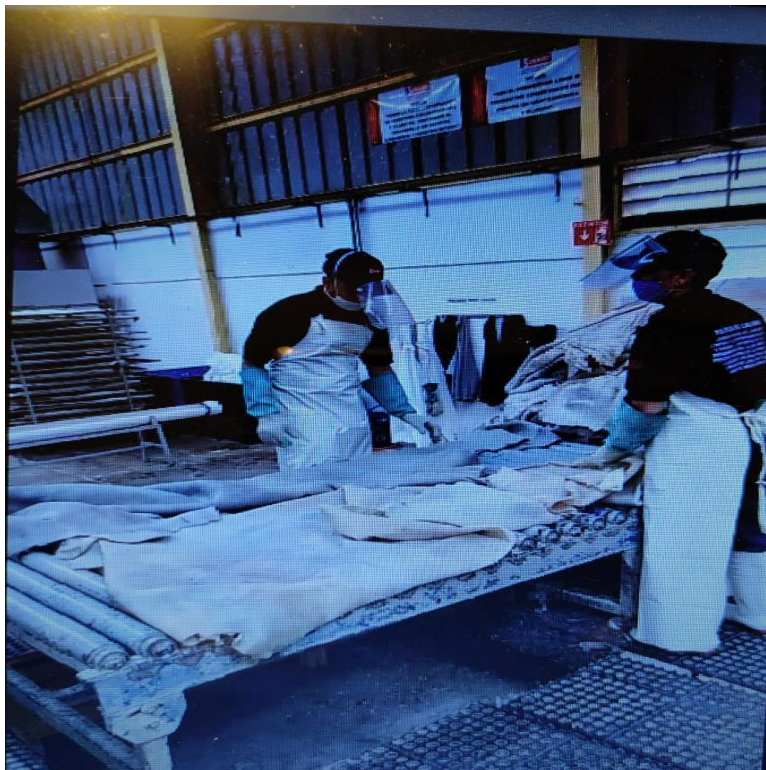
Imagen 17. Operadores colocando los cueros en una mesa de rodillos. Fuente: Tomada por los autores, (Planta Principal. 2021)
