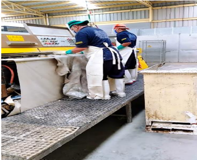
Imagen 16. Operadores metiendo los cueros a la máquina divididora. Fuente: Tomada por los autores, (Planta Principal. 2021)
